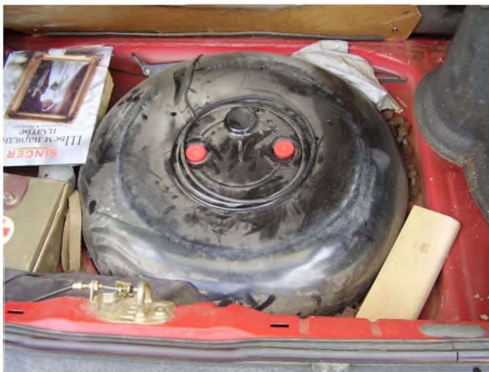
Obr. 3 Nádrž na LPG
