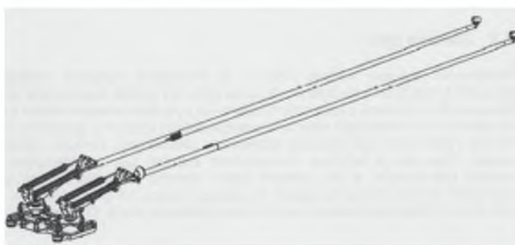
Obr. 13 Manuálna zberacia sústava LEKOV TSS 5.7/I
